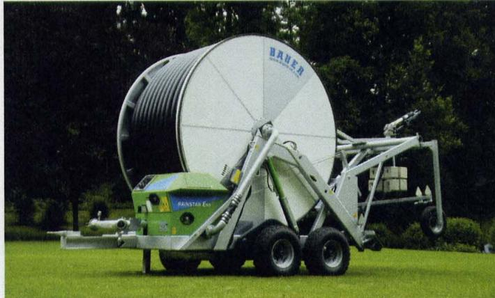
*Wasserführende Teile aus rostfreiem Metall und hohe Durchflussmengen zeichnen Rainstar-Beregnern in einer Sonderausführung aus.*
